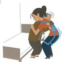
ロボット技術を用いて介助者のパワー・アシストを行う装着型の機器
