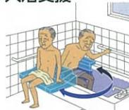
ロボット技術を用いて浴槽に入り出す際の一連の動作を支援する機器
