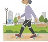
高齢者等の外出をサポートし、転倒予防や歩行等を補助するロボット技術を用いた装着型の移動支援機器
