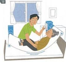
ロボット技術を用いて介助者による抱え上げ動作のパワー・アシストを行う非装着型の機器
