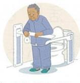
ロボット技術を用いてトイレ内の下衣の着脱等の排泄の一連の動作を支援する機器
